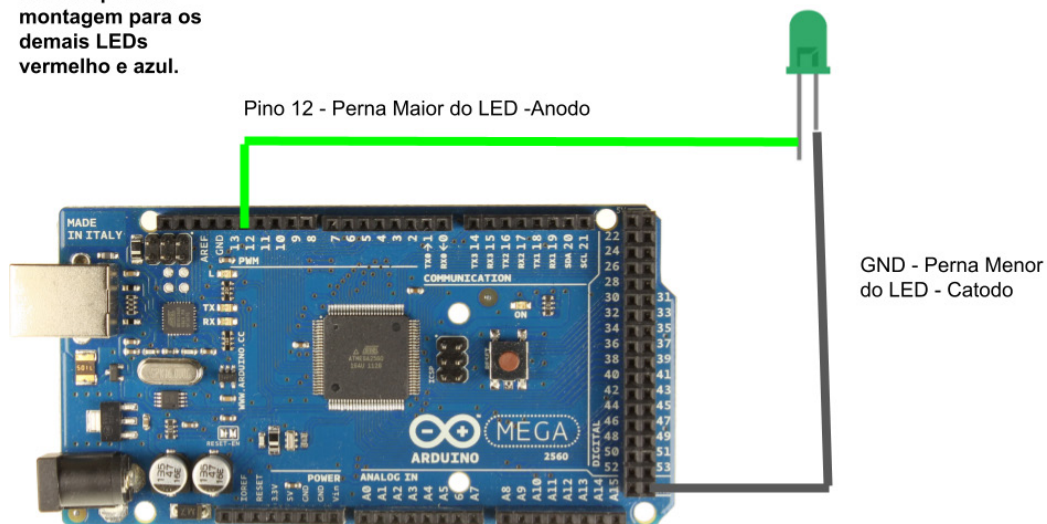
Imagem 01.03 - Esquemático de Montagem do Corpo com Arduino MEGA Parte 03 - Arduino MEGA + LEDs
